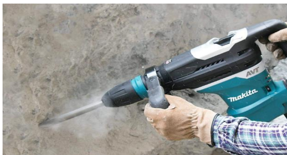
Figura 3 – 1_Martelete elétrico; 2_Serra a gasolina para corte de concreto armado. Fonte: Própria
